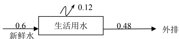
图 1 建设项目水平衡图（单位：m 3 /d）
