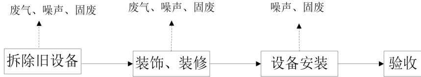
图3 施工期工艺流程图及产污节点图
